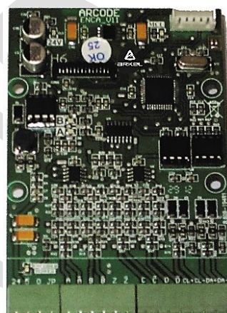
شکل 7. ج. برد انکودر ENCA مربوط به موتورهای گیرلس
